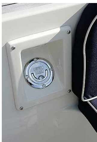
Gut erreichbar: Tankeinfüllstutzen in der Cockpitwand
