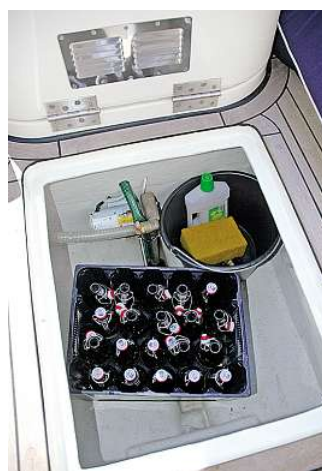
Die Innenfläche der GFK-Schale ist mit Topcoat versiegelt
